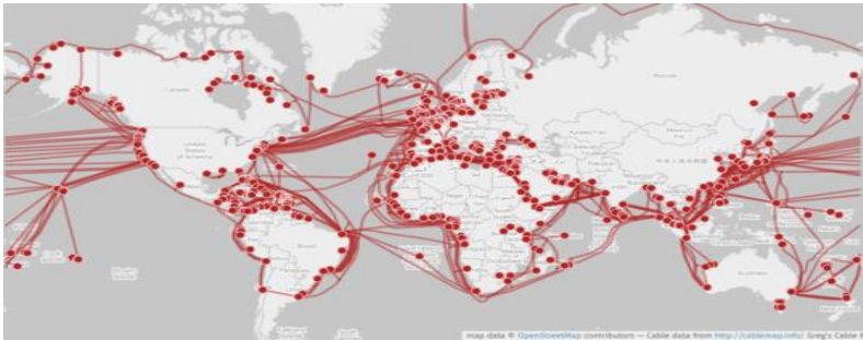
Şekil.4. İnternetin fiziksel altyapısı olarak hizmet veren belirgin deniz altı kablolarının yönlendirilmesi.
